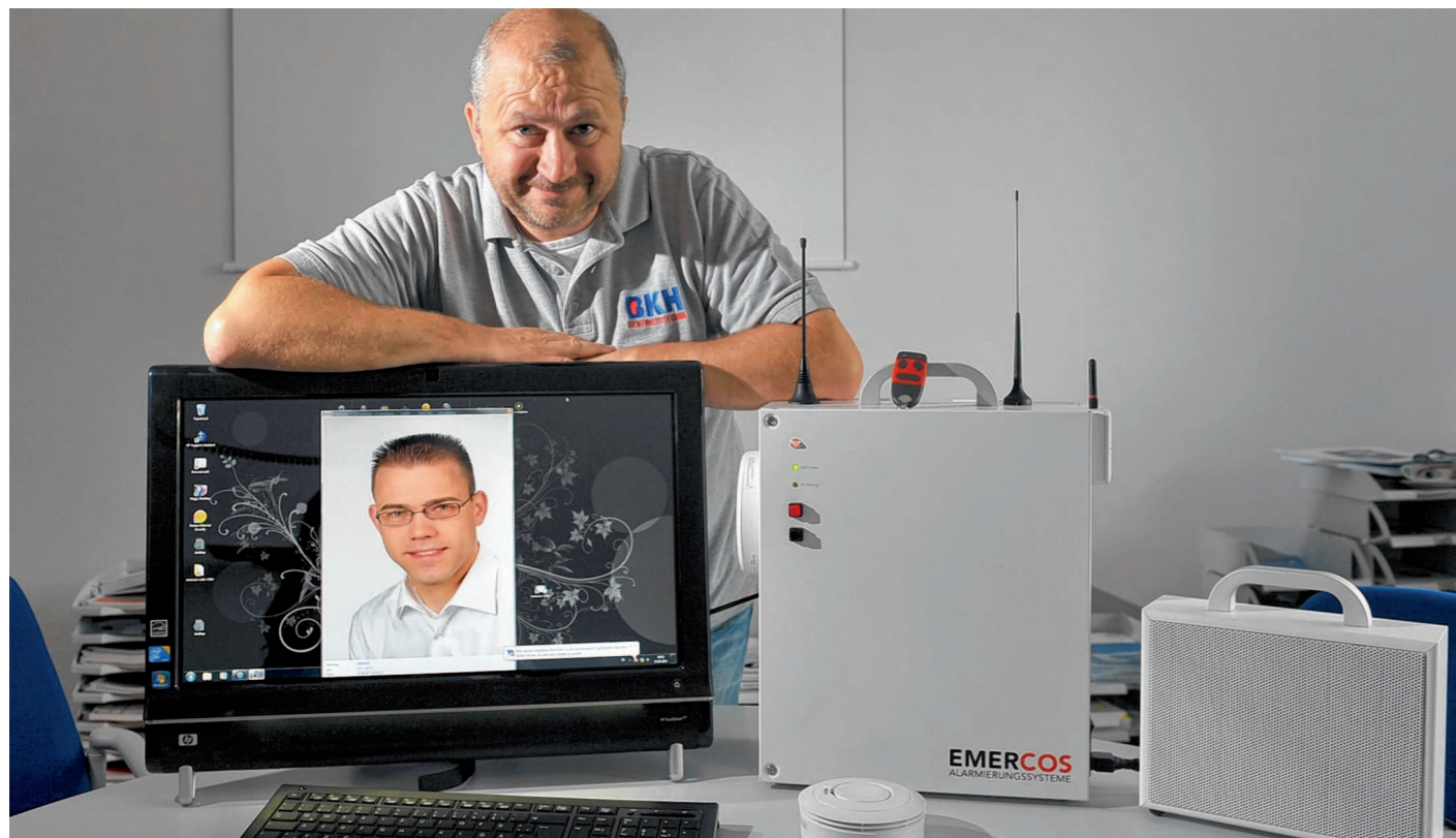
BKH-Geschäftsführer Patrick Kane mit dem neuen Amok-Alarmsystem. Die Lehrer sind mit Sendern ausgestattet (zu sehen zwischen den Antennen), mit deren Hilfe sie Alarm schlagen können. Im Sekretariat poppt dann eine Meldung auf – unter anderem kann ein Foto des Lehrers angezeigt werden. Bild: ri
